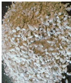
CONSUMO per sistema Terrazzo di ca. 10 mm di spessore: 15-19 kg/m<sup>2</sup> (in funzione del legante resinoso utilizzato)
